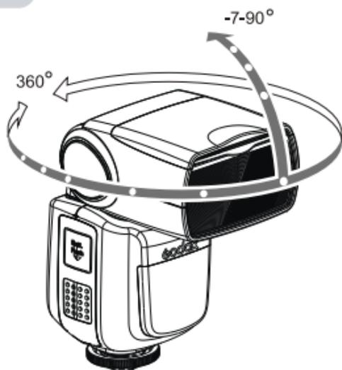
Чтобы установить направление отражения, удерживайте головку вспышки и поверните ее в направлении отражающей поверхности.
