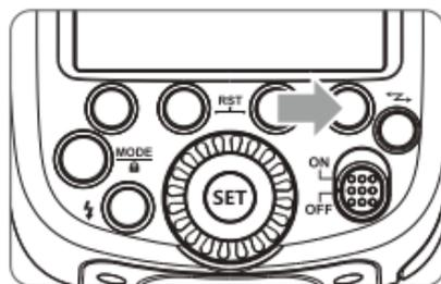
Нажмите функциональную кнопку 4 <SYNC>, чтобы индикация <▶▶> появилась на дисплее.
