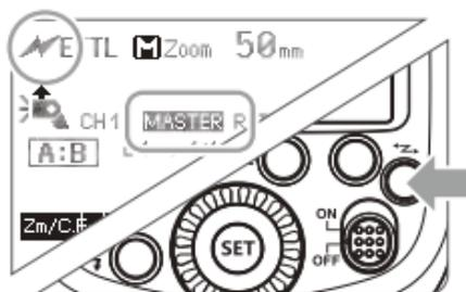
Нажимайте кнопку  $\leftarrow z \rightarrow$ , чтобы на экране появились индикации  $\langle \text{⚡} \rangle$  и  $\langle \text{MASTER} \rangle$ .
