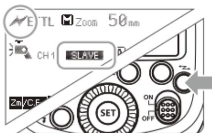
Нажимайте кнопку  $\leftarrow z \rightarrow$ , чтобы на экране появились индикации  $\langle \text{⚡} \rangle$  и  $\langle \text{SLAVE} \rangle$ .
