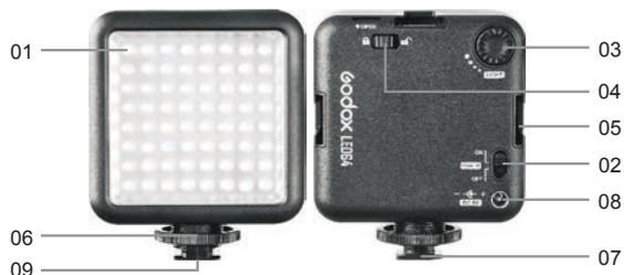
(1) 64 LED светодиода (2) Выключатель питания (3) Регулятор яркости (4) Замок отсека аккумуляторной батареи (5) Башмак для соединения осветителей между собой (6) Стопорное кольцо (7) Пятка для крепления осветителя на камере (8) Разъем питания постоянного тока (9) Отверстие с резьбой 1/4"
