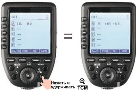
Функция изменения TCM позволяет сохранять настройки вспышки при переключении из режима TTL в ручной режим.
