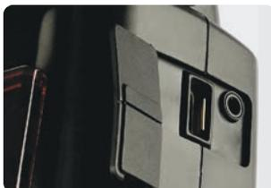
Разъём для подключения FT-16S
