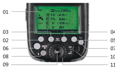
(1) ЖК-панель (2) Кнопка 1 (3) Кнопка 2 (4) Кнопка 3 (5) Кнопка 4 (6) Кнопка выбора режима (7) Кнопка выбора беспроводного режима работы (8) Кнопка тест / индикатор готовности вспышки (9) Кнопку подтверждения выбора (10) ВКЛ / ВЫКЛ (11) Диск выбора
