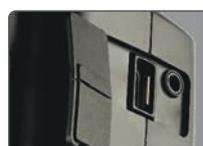
Беспроводной порт управления и 2,5-мм разъем для кабеля
