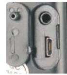
Разъём для синхрокабеля
