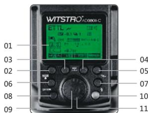
(1) LCD экран (2) Функциональная Кнопка 1 (3) Функциональная Кнопка 2 (4) Функциональная Кнопка 3 (5) Функциональная Кнопка 4 (6) Кнопка выбора режимов (7) Кнопка выбора беспроводного режима (8) Кнопка включения/выключения (9) Кнопка подтверждения выбора (10) Кнопка «Тест»/Индикатор готовности вспышки (11) Колесо выбора
