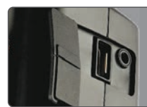
Беспроводной порт управления и 2,5-мм разъем для кабеля
