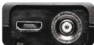
Передатчик: Micro-USB порт и PC-разъем
